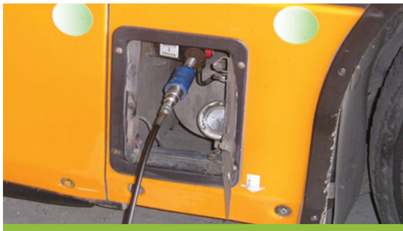
Figura 5 - L'autobus nella stazione di rifornimento idrometano e dettaglio del rifornimento presso SOL SpA.
