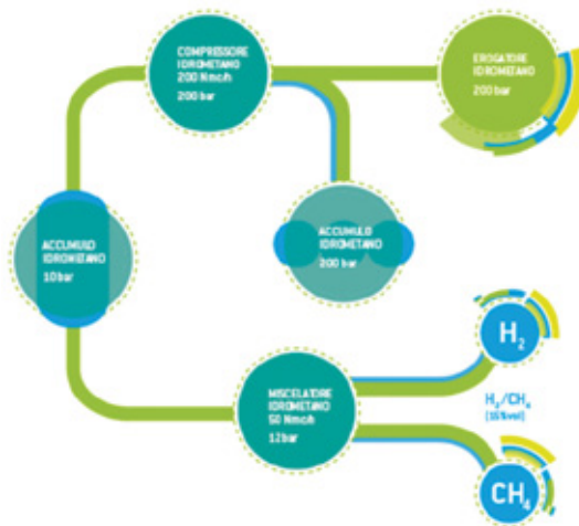
Figura 4 - Schema di flusso della stazione di rifornimento idrometano
